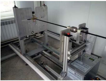
Фрагмент станда для поверки уровнемеров с установленным поплавковым уровнемером
