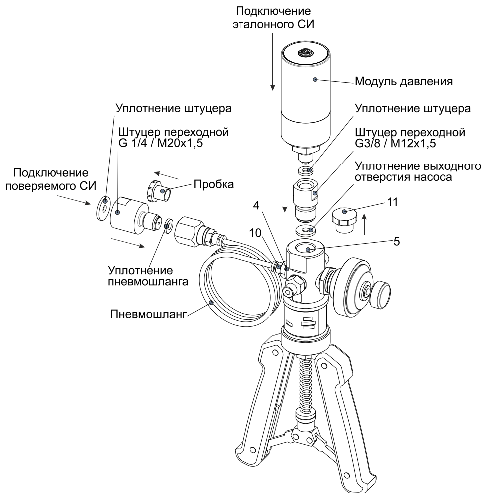
Рисунок 2 – Подключение эталонного и поверяемого СИ к насосу ручному пневматическому ЭЛМЕТРО-ПРН-25
