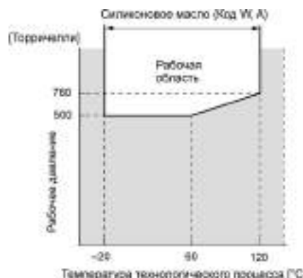
Рис. 2 Соотношение между температурой технологического процесса и рабочим давлением
