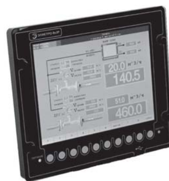
Рис.4. Регистратор ЭлМетро-ВиЭР-104К с мнемосхемой
