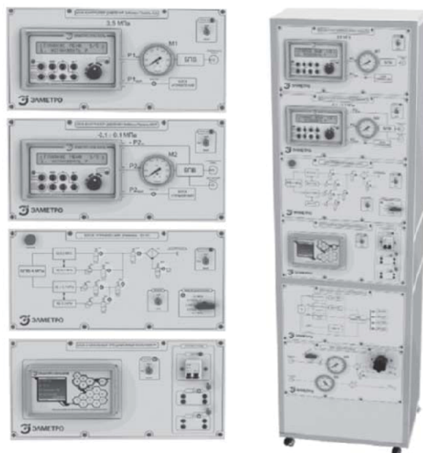
■ Рис. 1. Калибровочная станция для датчиков давления на базе контроллеров ЭЛМЕТРО-Паскаль
